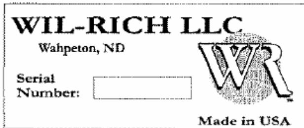
При заказе деталей всегда указывайте модель и серийный номер. Напишите номер в предназначенном для этого месте. Табличка с серийным номером расположена на основной раме в переднем левом углу.
